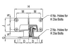
VERTICAL HORIZONTAL MAXIMUM LABEL DYNAMIC DYNAMIC REFERENCE LOAD COLOUR STIFFNESS STIFFNESS (kg) (kN/m) (kN/m) YELLOW 350 594 2376 BLUE 562 975 3680 MP(B)M GREEN 660 1212 4848 SIŻE 1 RED 725 1562 6250 BLACK 1000 2303 8748 YELLOW 635 1067 4477 BLUE 900 1587 6670 MP(B)M SIZE 2 GREEN 1060 2160 9072 RED 1440 2750 11562 BLACK 1590 3820 16065
